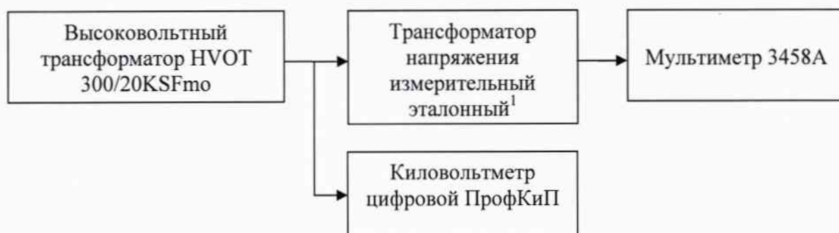
Рисунок 1 – Структурная схема подключения приборов для определения относительной погрешности измерения среднеквадратических значений напряжения переменного тока синусоидальной формы частотой 50 Гц.
